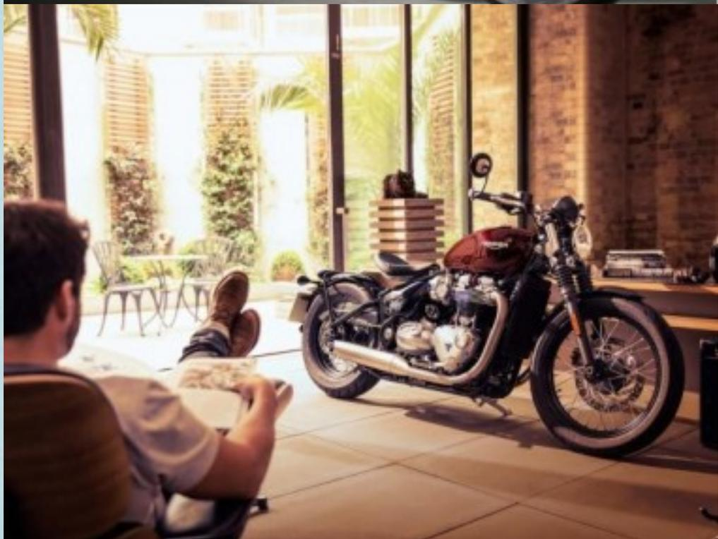
**Motor da Bonneville Bobber Trazendo o já conhecido motor de 1200cc que equipa a nova linha Bonneville T120, a nova Bonneville Bobber 2017 conta com motorização de dois cilindros High-Torque (HT), traz arrefecimento líquido e transmissão de seis velocidades. O motor é capaz de gerar a potência de 80 cavalos a 6.500 rotações e traz torque de 10,5kgf.m aos 3.100 giros, garantindo melhor desempenho mesmo em rotações mais baixas. É uma boa potência e ótimo torque para o estilo da motocicleta.**
