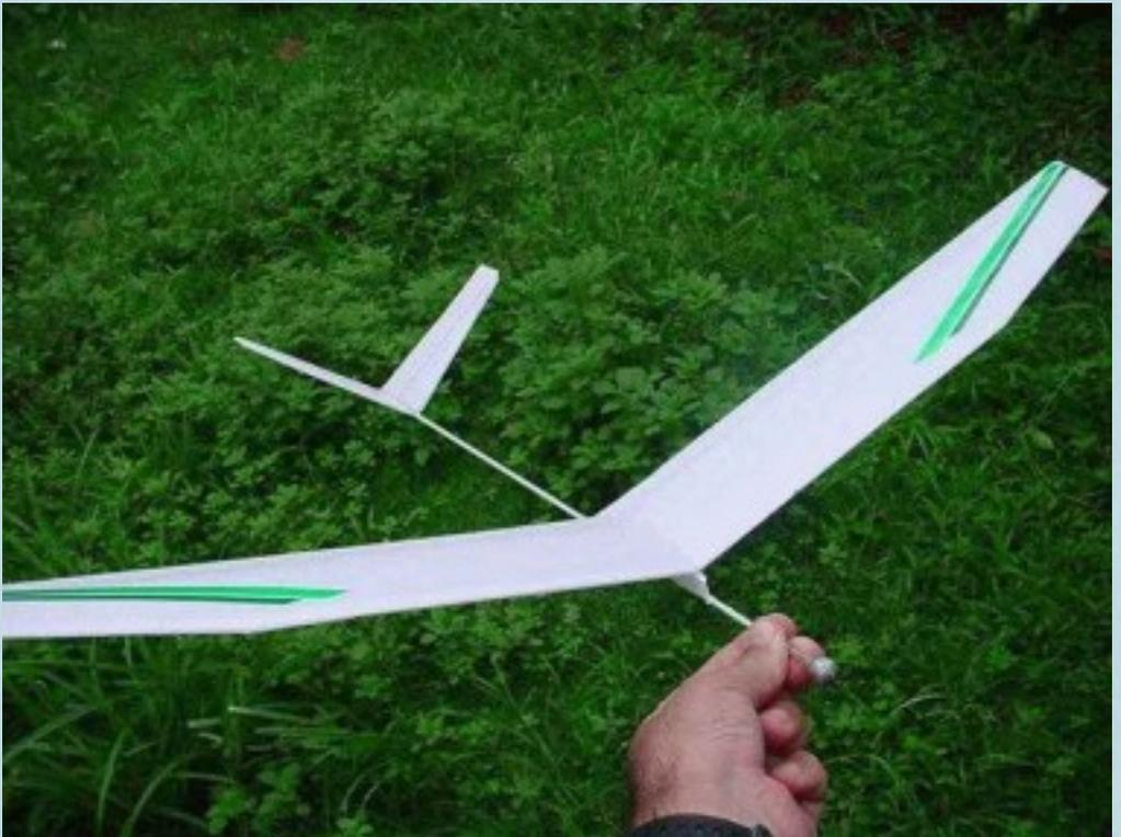
**Procedimentos** : Corte dois pedaços de 20 cm de comprimento e 6 cm de largura para as asas.
